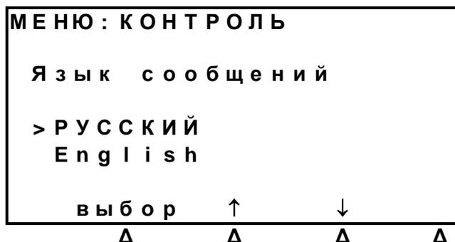
Установленный язык отмечен курсором «>». Переключение между языками производится нажатием МФК  $\Delta$   $\uparrow$  или  $\downarrow$ .
